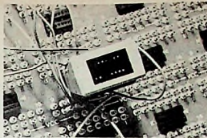
Afb. 4a. Logische clip van Jermijn. Er zijn nu uitvoeringen beschikbaar voor TTL, HTL, CMOS. Rodelco, Rijswijk.
